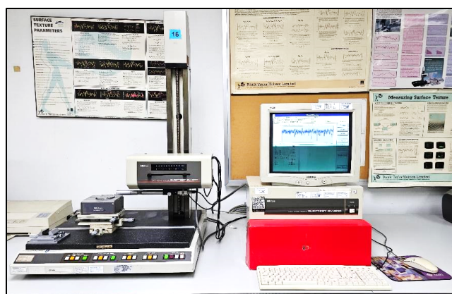
Fig. 5. Surftest machine SV600
