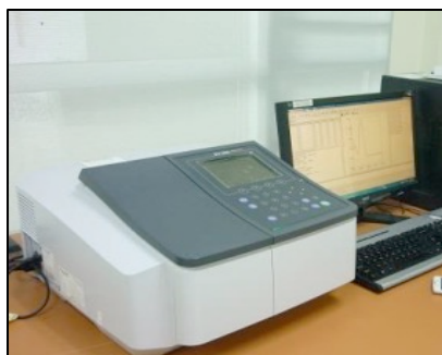
Fig. 1. UV-1800 SHIMADZU UV Spectrophotometer
